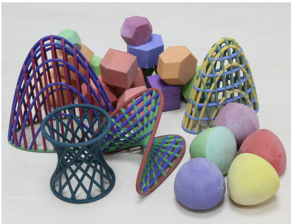
Рис. 2. Модели, подготовленные в лаборатории ДВГ с помощью собственных программ и напечатанные на 3D-принтере ZPrinter 450. Поверхности, ограничивающие тела, состоят из большого количества треугольников, выведенных в STL файл
